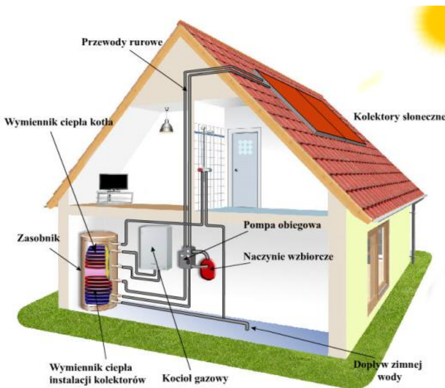
Ryc. 19. Schemat instalacji kolektorów słonecznych w domu jednorodzinnym
